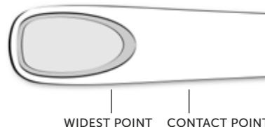
Das FAST GRIP TAIL ist ein kurzes Skienteil, wobei der Kontaktspunkt und die breiteste Stelle des Skientes weit hinten liegen. So entsteht ein aggressiveres, direkteres Aussteuern aus der Kurve.
