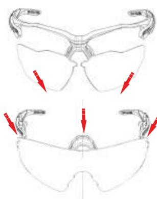
Il sistema di sostituzione delle lenti chiamato Easy-Change è una delle tecnologie di base dei nostri occhiali sportivi. Ogni modello ha un sistema differente di sostituzione delle lenti. La forma delle lenti e della montatura interagiscono differentemente. La tecnologia Easy-Change vi permette di cambiare facilmente le lenti per adattare i vostri occhiali ad ogni condizione di luce.
